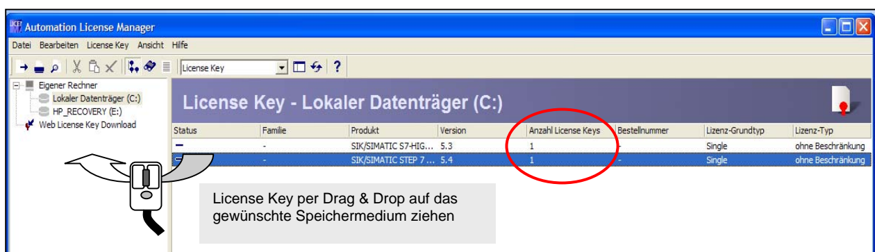
Bild 4-2 : Verschieben des License Key für die zeitweise Authorisierung unterschiedlicher PC
